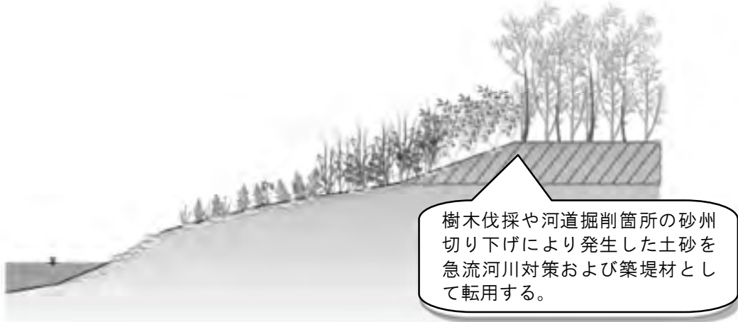
河道掘削や樹木伐採による発生土の有効利用
