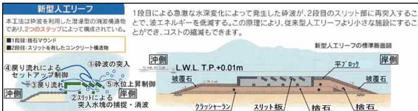
図 - 10 新型人工リーフの構造とその機能
