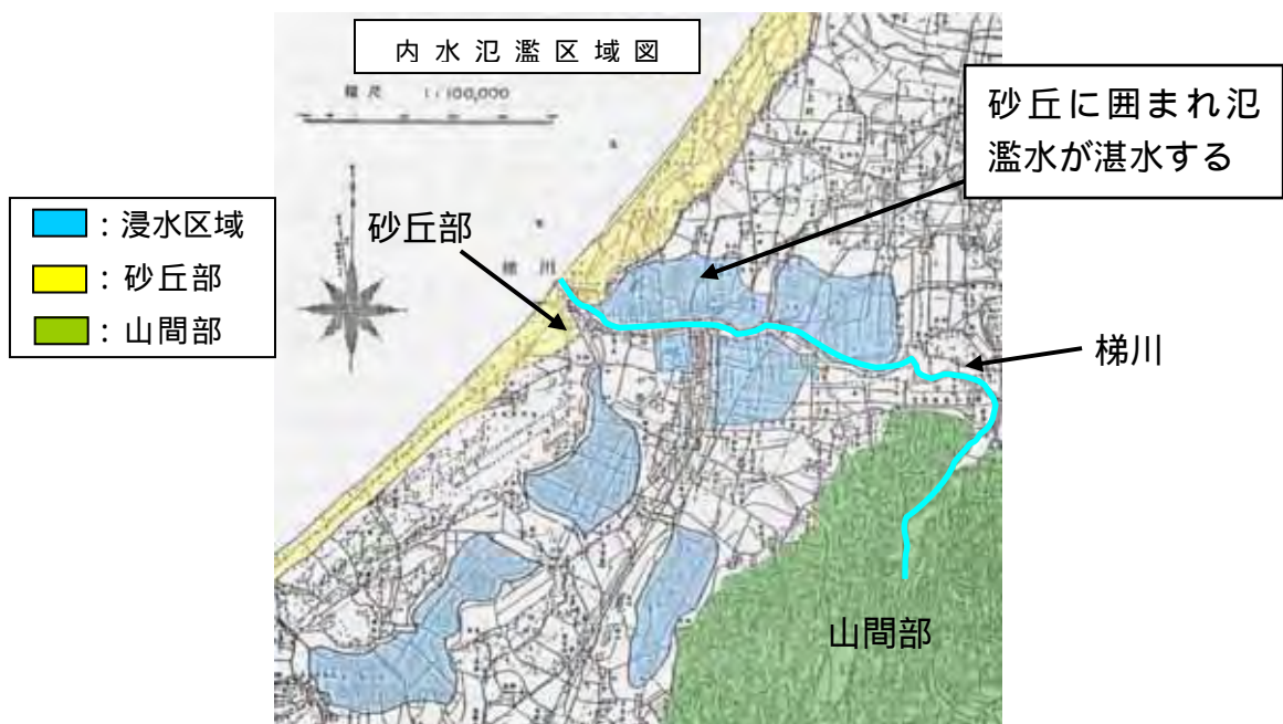
昭和43年の内水による浸水実績
