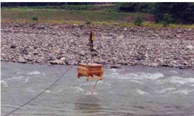
河床低下計測 レーダーによる観測
