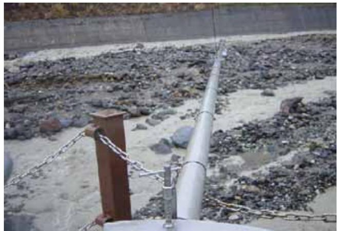
超音波式水位・流速計による流量把握
