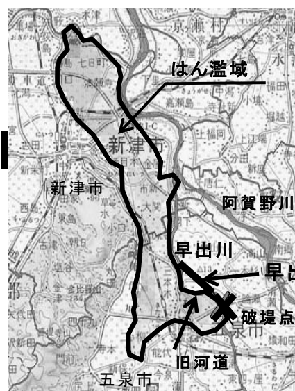
旧河道でH16年7月13日規模の洪水が発生し破堤した場合の氾濫シミュレーション結果
