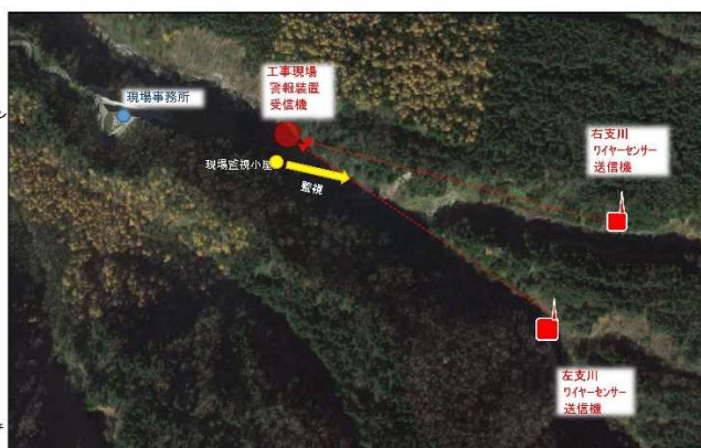
令和4年度 小鍋谷第14号砂防堰堤工事 土石流警報システム
