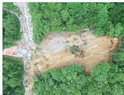
【令和2年 14号堰堤左岸側斜面崩落】
