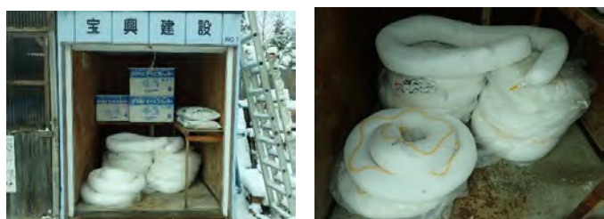
オイルフェンス備蓄品
