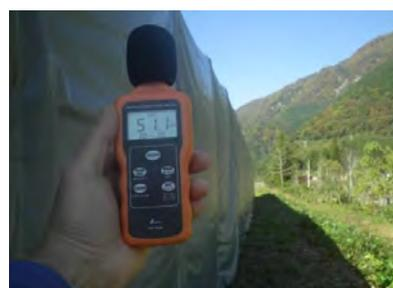
振動対策としては、作業ヤードの取壊し影響範囲に、万が一の取壊し破片落下にも衝撃を吸収するサンドマット(t=500)を設置し、振動が住宅地に及ばないようにしました。また、振動測定器による作業中の振動測定も行いました。
