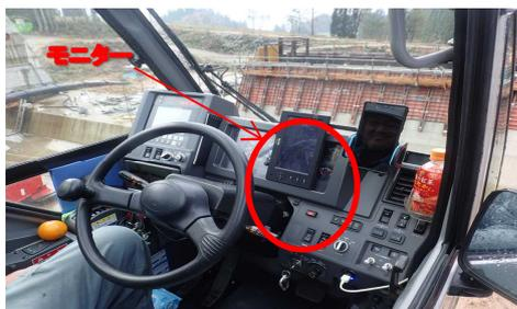
クレーンオペレーターから目視ができないため打設箇所にワイヤレスカメラを設置した。オペレーターから作業所の内容が確認でき、クレーン作業時の接触事故防止に貢献できた。
