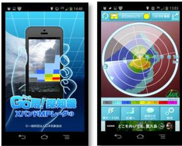
ゲリラ豪雨に対応するため、雨雲レーダー(XバンドMPレーダー)による作業判断基準を定めた。現場雨量に関わらず、施工箇所付近(5km圏内)に5mm以上の雨雲が発生している場合は、作業一時中止とした。雨雲レーダーによる作業判断基準を設定したことで、早めの避難が行える体制となった。今年度、作業中に土石流の発生はなかったが、雨雲レーダー確認による作業中止や一時待機などは数回あった。
