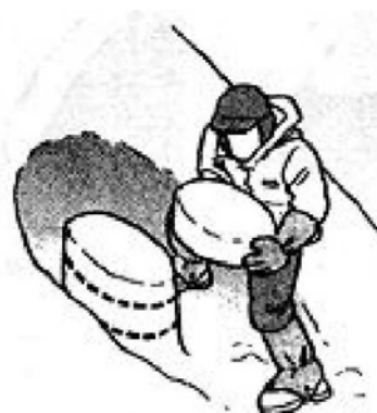
③軽く引くだけで、円盤状にはがれたら弱層あり。①②の作業を繰り返し、深さ 70センチまでテストする
