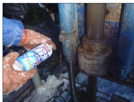
バーナー(左)、解氷スプレー(右)によるツールの解氷作業
