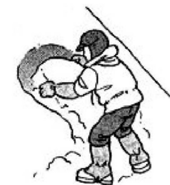
①安全な斜面を選び、雪面に直径 30センチほどの円を描く
