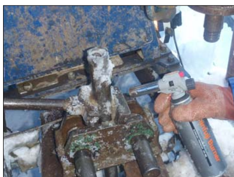
バーナー(左)、解氷スプレー(右)によるツールの解氷作業
