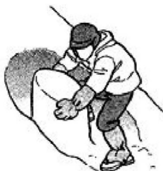
②高さが 20～30センチほどの円柱を掘り出し、上部を両手で抱えて引く
