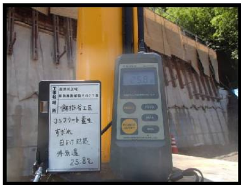
〔写真-9 外気温及び簾内部温度測定〕
