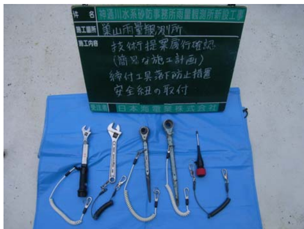
【写真2 工具への安全紐取付状況】
