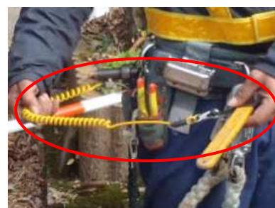
写真5. 工具落下防止器具 ⇒ワイヤーで工具が 地上まで落下しない
