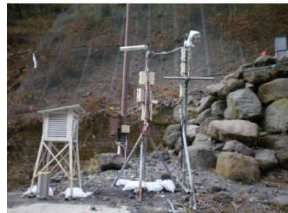
〔写真-10 水位監視Webカメラ及び気象観測機器類〕
