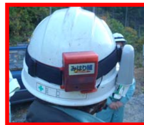
ヘルメットに取付けたセンサー
