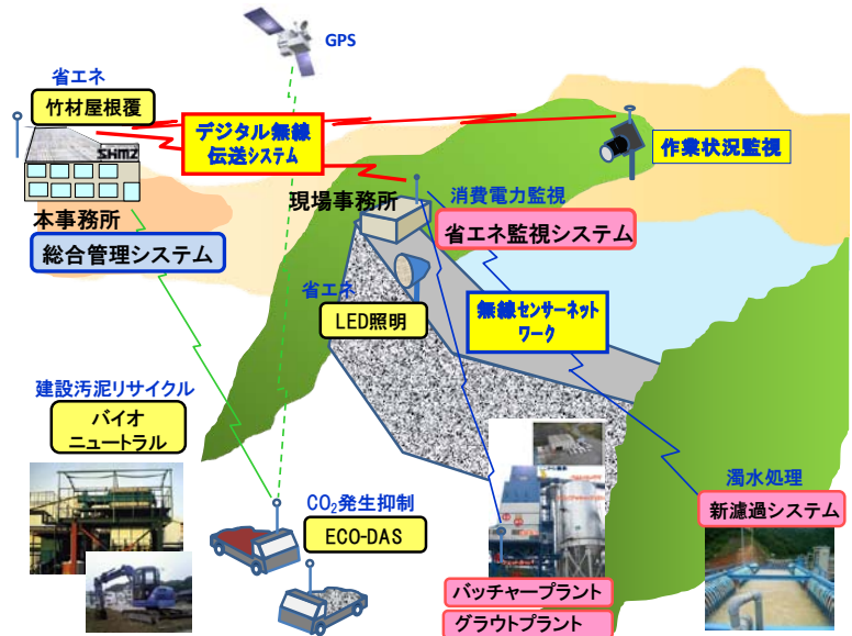
図-7 大津呂ダムでのスマートサイトシステム適用事例
