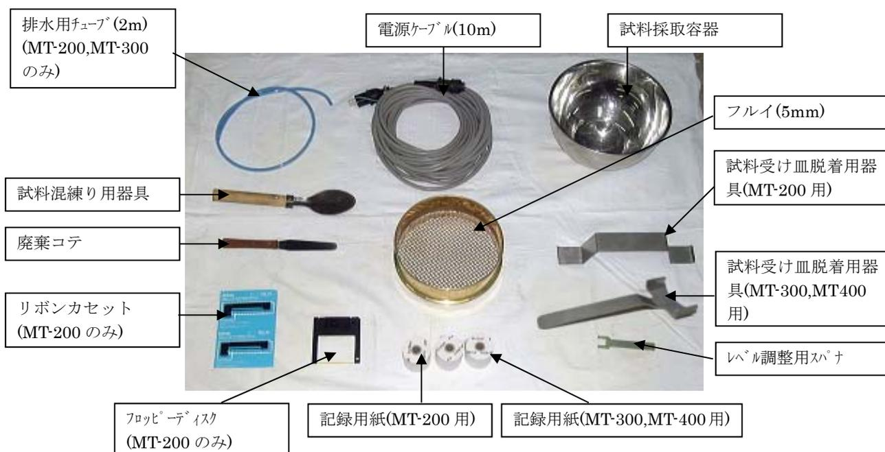
写真2-2 測定器の付属品及び消耗品
