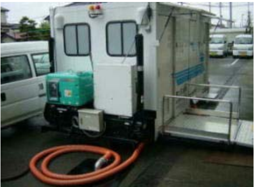
下水道マンホールに接続し、し尿を処理
