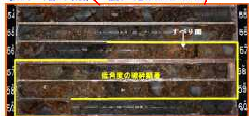
【B38すべり面コア状況】 推定すべり面 56.75m～58.74m
