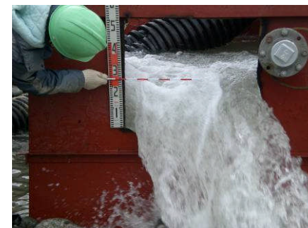
排水量の三角堰による測定状況
