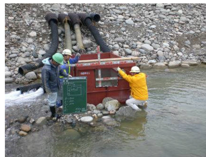
排水量の三角堰による測定状況
