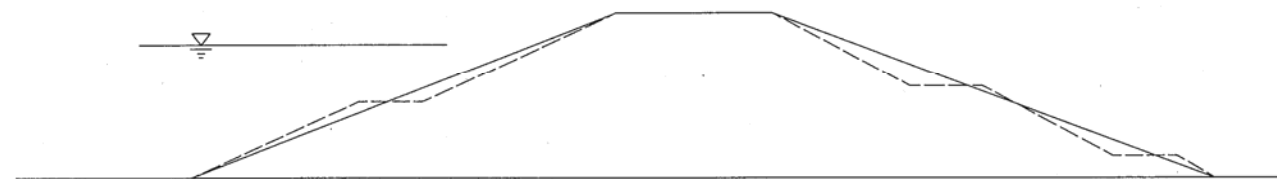
図2-2 小段のある法面を緩勾配の一枚法にする例
