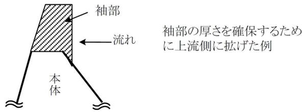
図 3-8 袖部の断面
