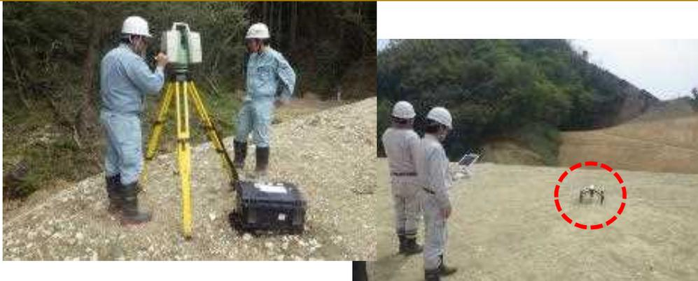
レーザースキャナー、UAVそれぞれの機器で精度確認を実施
