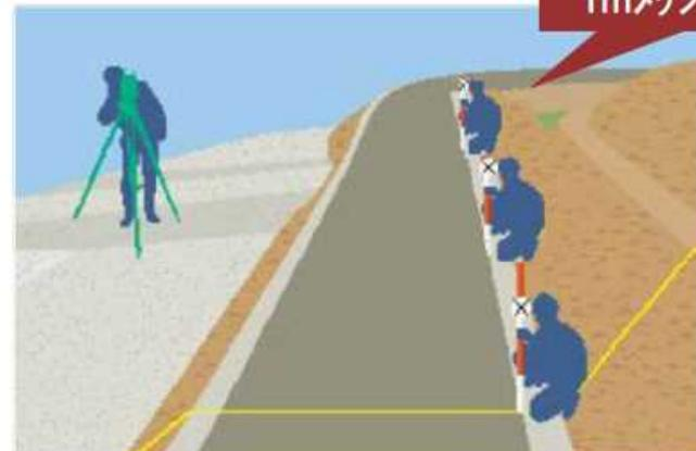
点密度で1m間隔以内(1点/m<sup>2</sup>以上)で概ね等間隔で得られるよう計測する。
