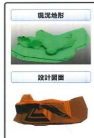
3次元測量点群データ(現況地形)と設計図面との差分から、施工量(切り土、盛り土量)を自動算出。
