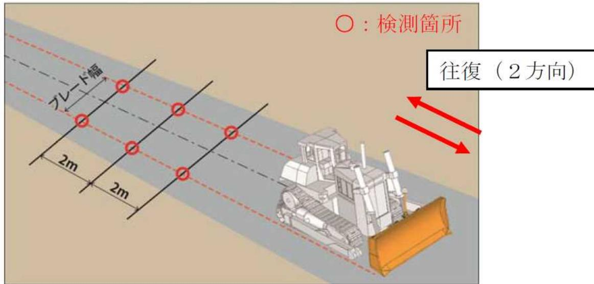
図3-4 テスト走行による検測例
