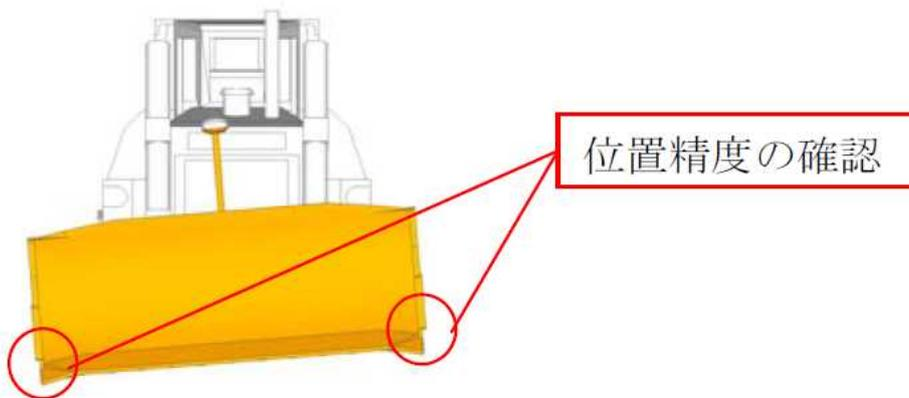
図 3-3 ブルドーザの作業装置位置の精度の確認方法
