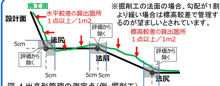
図-4 出来形管理の測定点(例:掘削工)
