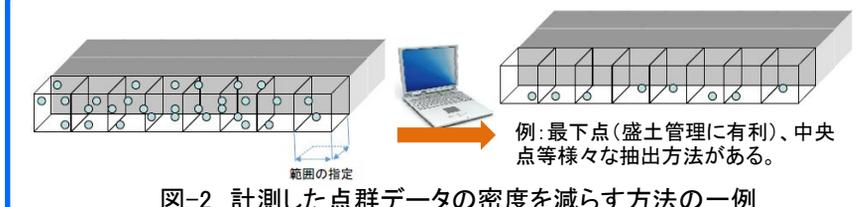
図-2 計測した点群データの密度を減らす方法の一例
