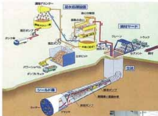
汚泥処理設備概要
