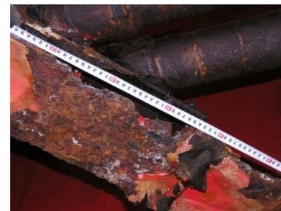
鋼桁の腐食
