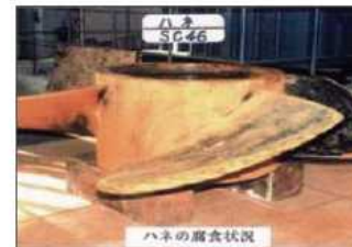
ポンプインペラの発錆状況
