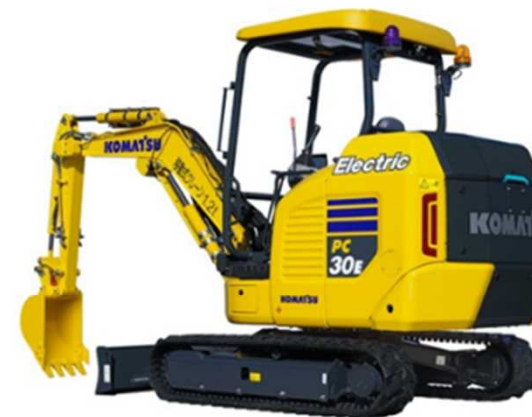
バッテリー式電動小型油圧ショベルの例(出典:コマツHP)
