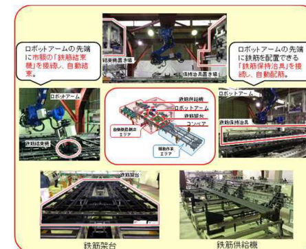
鉄筋組立自動化システム『ロボタス』の開発【三井住友建設株式会社】
