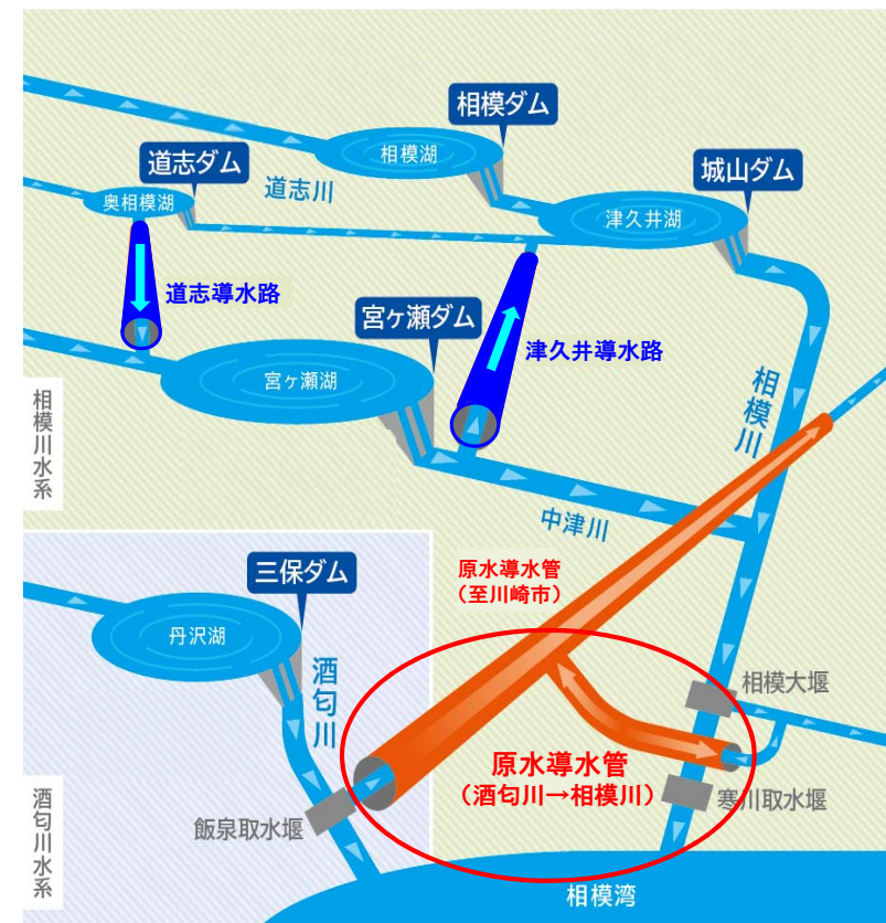
相模川水系、酒匂川水系の原水を融通できる 原水導水管を活用(イメージ図)
