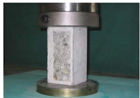
ボス供試体の圧縮試験状況
