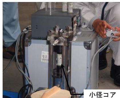
小径コアの圧縮試験状況
