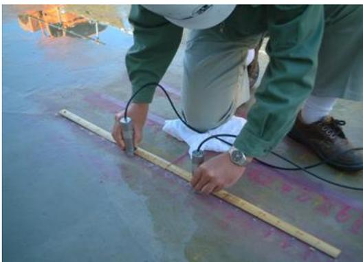
超音波測定による試験状況
