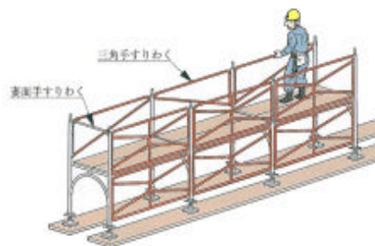
2層目手すり機材の組立て
