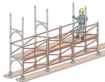
建わくの取付け
