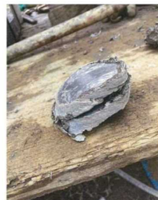
ボーリングでくり抜いた塩ビ管の一部
