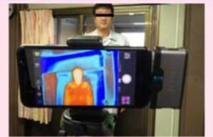
サーモグラフィカメラによる体温計測
