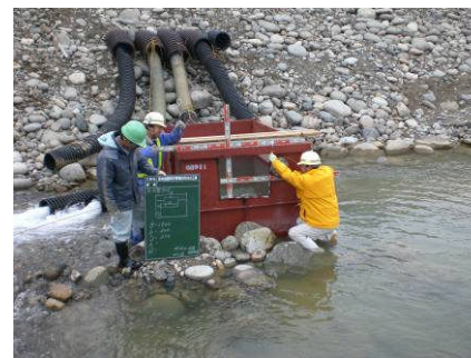
排水量の三角堰による測定状況
