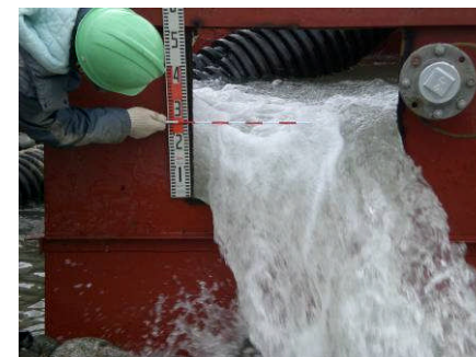
排水量の三角堰による測定状況
