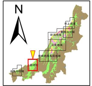
高田平野は海岸線に沿って砂丘が張り出し、関川は砂丘の切れ目の狭い範囲で日本海へ流出しています。高田平野は主に粘性土から構成されており液状化の要因に乏しい地盤構成です。しかし、直江津地区を中心に宅地や工場の盛土造成地が広範囲に広がっており、可能性のある範囲を形成しています。
