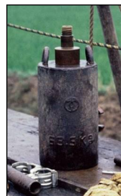
標準貫入試験(上)とドライブハンマー(右) ※文献 2)より転載
