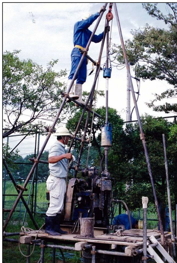
標準貫入試験(上)とドライブハンマー(右) ※文献 2)より転載
