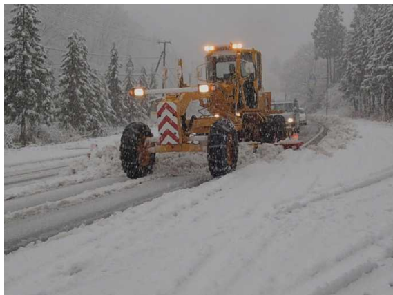
除雪作業状況 (除雪グレーダ)
