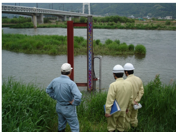
杭瀬下水位観測所点検状況
