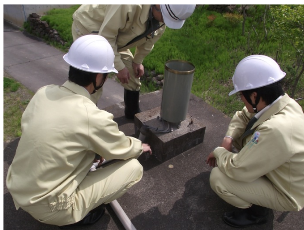
生田雨量観測所点検状況
