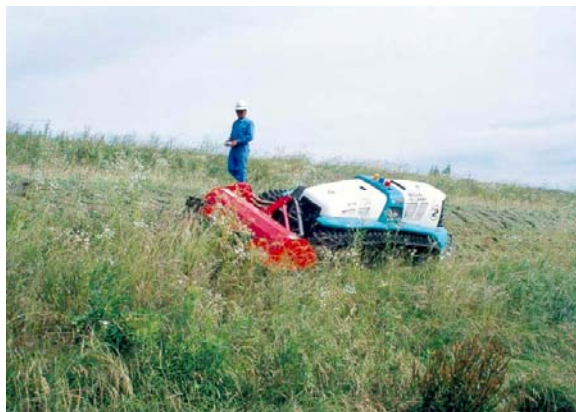
▲大型遠隔操縦式草刈り機による堤防除草
