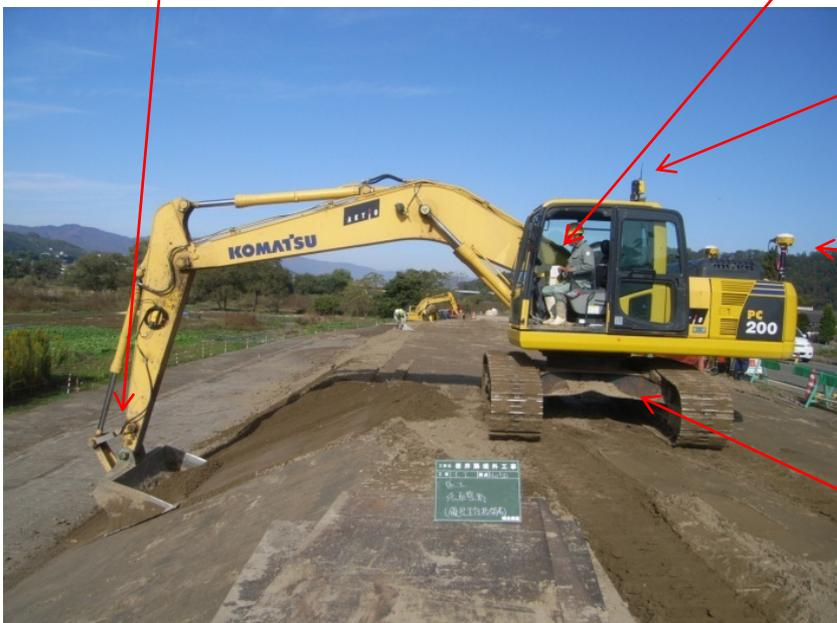
基地局に設置したGNSS受信機からの補正データを無線機でバックホウ側に送る事によって、バックホウに設置したGNSS受信機の「XYZ」位置が判明します。バックホウの「ブーム」「アーム」「バケット寸法」を事前計測し、その値を「コントロールボックス」に入力しておきます。バックホウの「ブーム」「アーム」「チルトセンサー」から送られて来る傾斜情報により、バケット先端部の「XYZ」値を割り出す事が出来ます。
