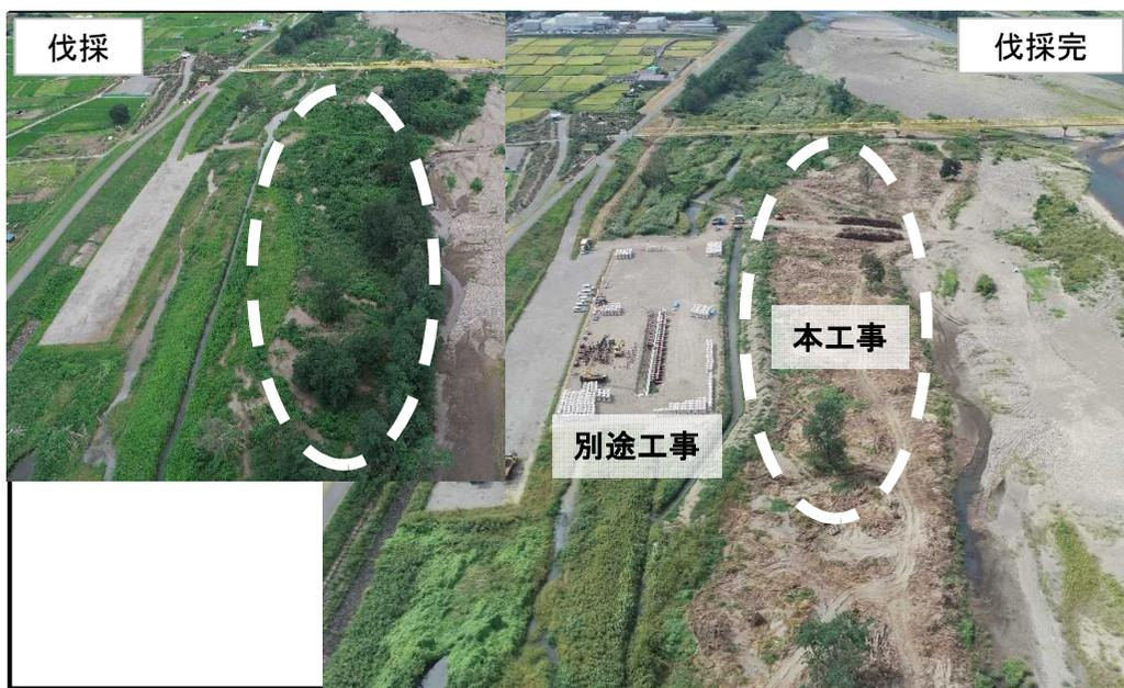
本工事は、国土強靱化工事の一環として、洪水の流下の支障となる河道内樹林を間伐し樹木の繁茂による流下能力の低下、砂洲の固定化に伴う河岸近接物の偏流箇所を改善を図る工事です。
