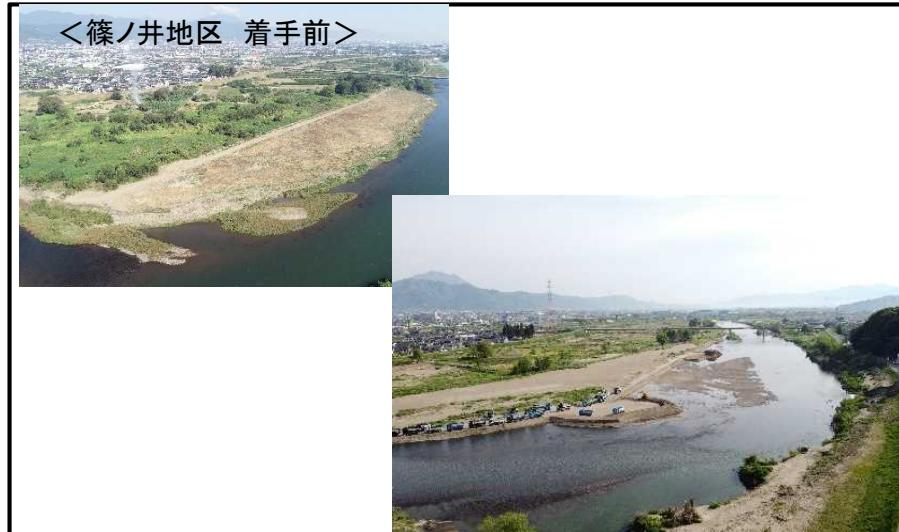
本工事は、大雨による出水において洪水被害を防止するため、長野市篠ノ井横田地先にて河道掘削( $V=26,680m^3$ )を行い「流下能力の向上」を目的とした工事であるとともに、長野市柳原～屋島地先にて築堤を行う工事である。
