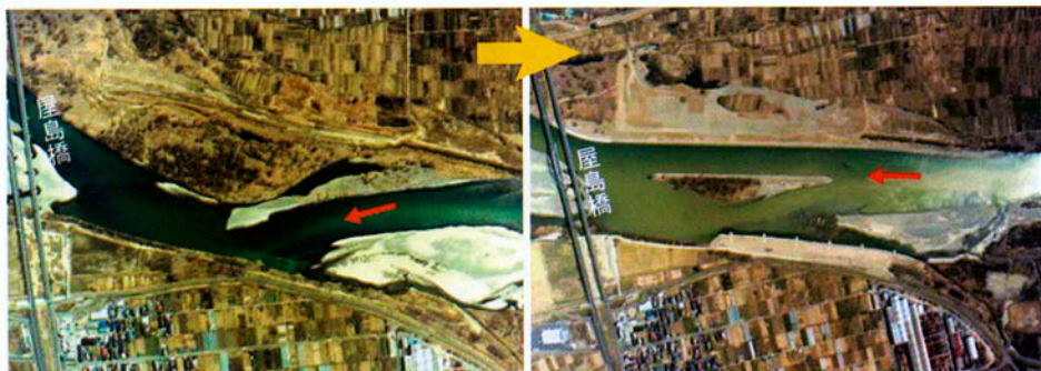
河道掘削前 中州の影響で流路が左岸側に流れています。
