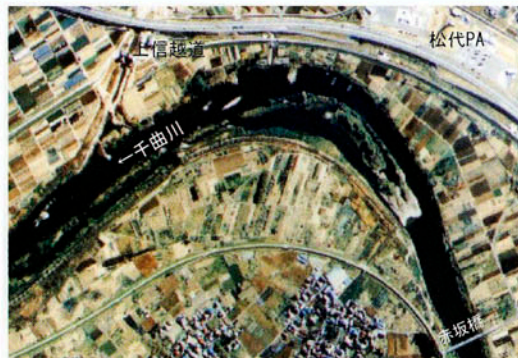
施工後（平成7年11月） 樹林地を残した中州の掘削によりビオトープが生まれました。
