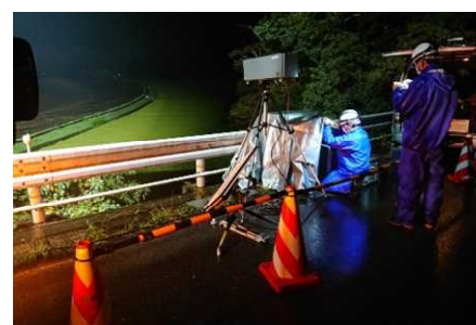
安曇野市 木戸橋上流 (8月14日 20:00) Ku-SAT(衛星通信可搬局装置)による河川監視
