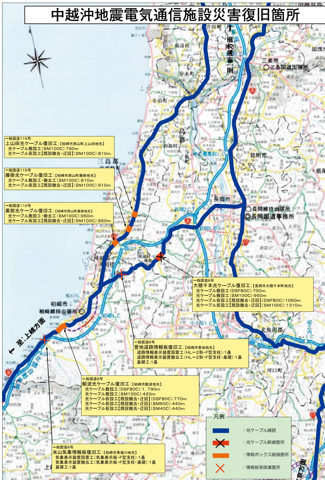
図4-5-1 光ファイバケーブル、道路情報板等本復旧工事箇所
