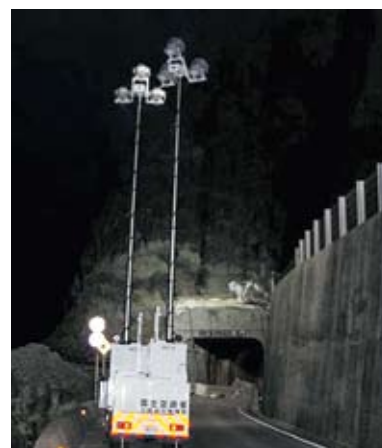
写真3-10-1 照明車による監視 (八世乃洞門)
