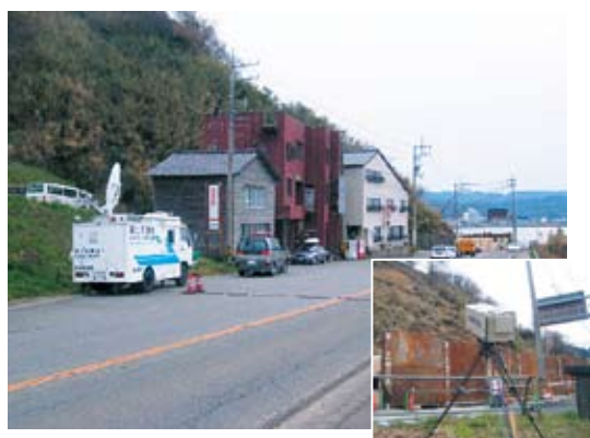
写真3-10-9 衛星通信車・カメラの設置・運用状況(左)、配信映像(右)
