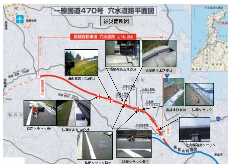
図2-1-2 穴水道路の被災状況
