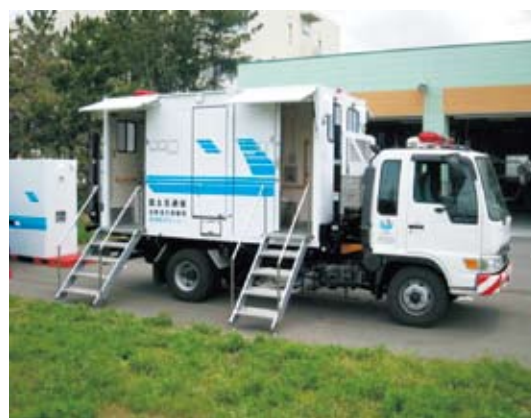
写真2-2 災害用トイレ(車載時)
