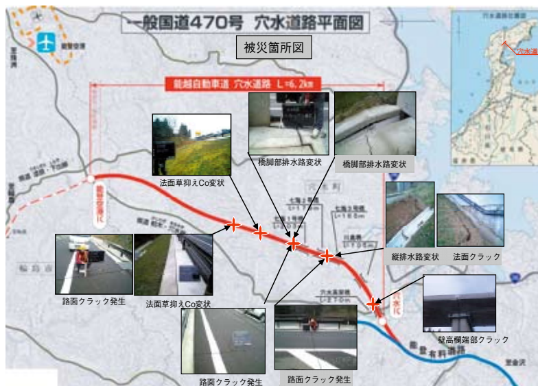
図2-1-2 穴水道路の被災状況
